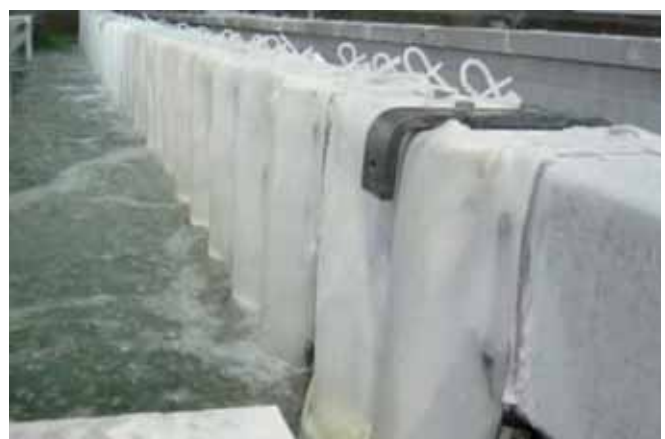
Abb. 5: Kathodenumhüllung zur Reduzierung der Schwefelsäure-Aerosole beim Eloxieren
