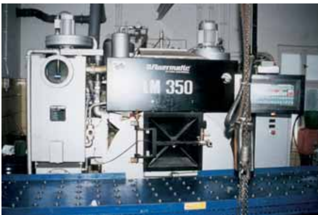
Abb. 3: Geschlossene Entfettungsanlage mit Tetrachlorethen (Per) als Reinigungsmittel
