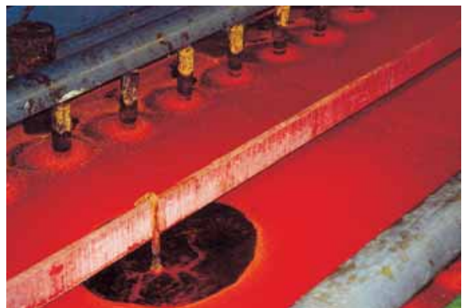
Abb. 4: Einsatz von Netzmitteln beim Verchromen
